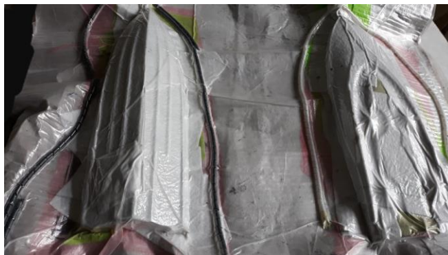
Figura 15. Processo a vácuo de colocação da fibra de carbono
