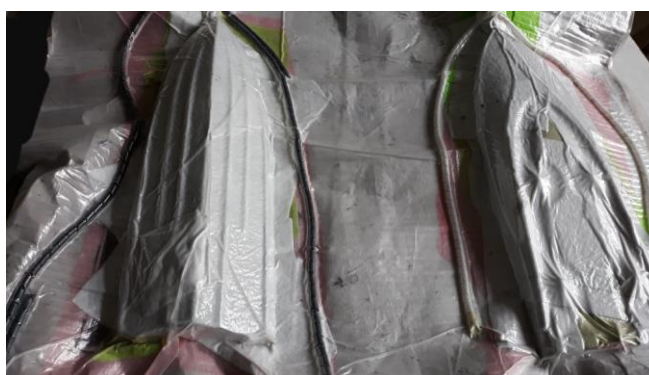
Figura 2. Processo a vácuo de colocação da fibra de carbono (Fonte: Acervo Pessoal)
